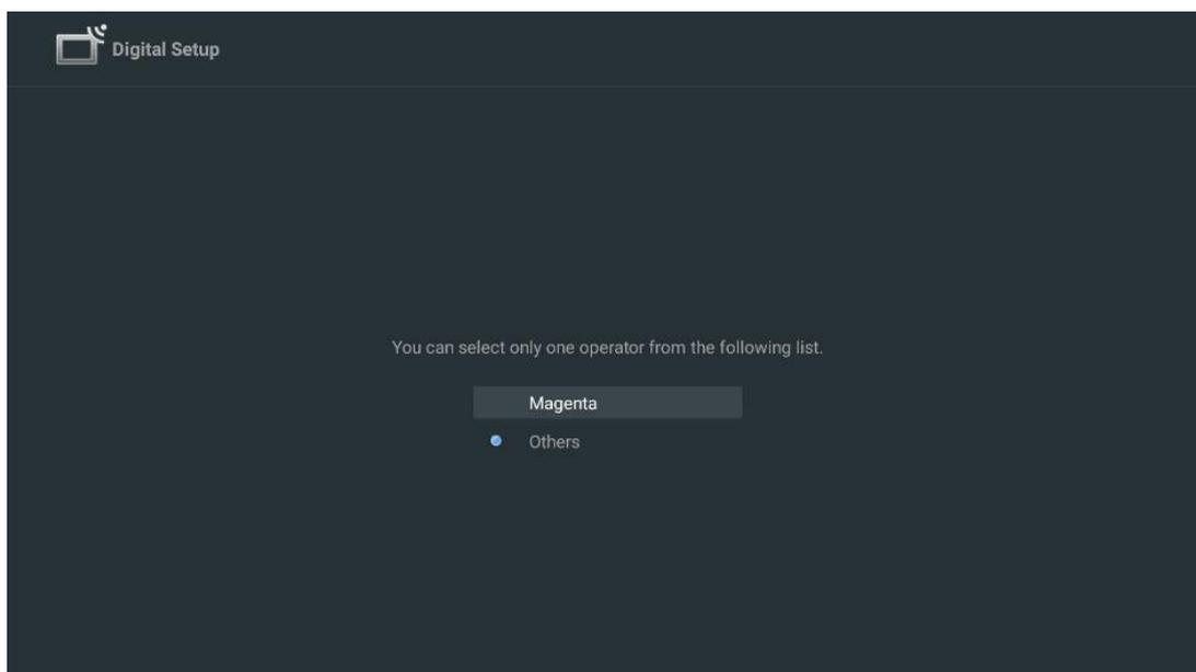
**Autres** : Sélectionnez l'option Autres si votre câblo-opérateur n'est pas répertorié ou si votre téléviseur est connecté à un système de câble local. Sélectionnez Type de balayage et appuyez sur **OK** pour afficher les options de balayage.
