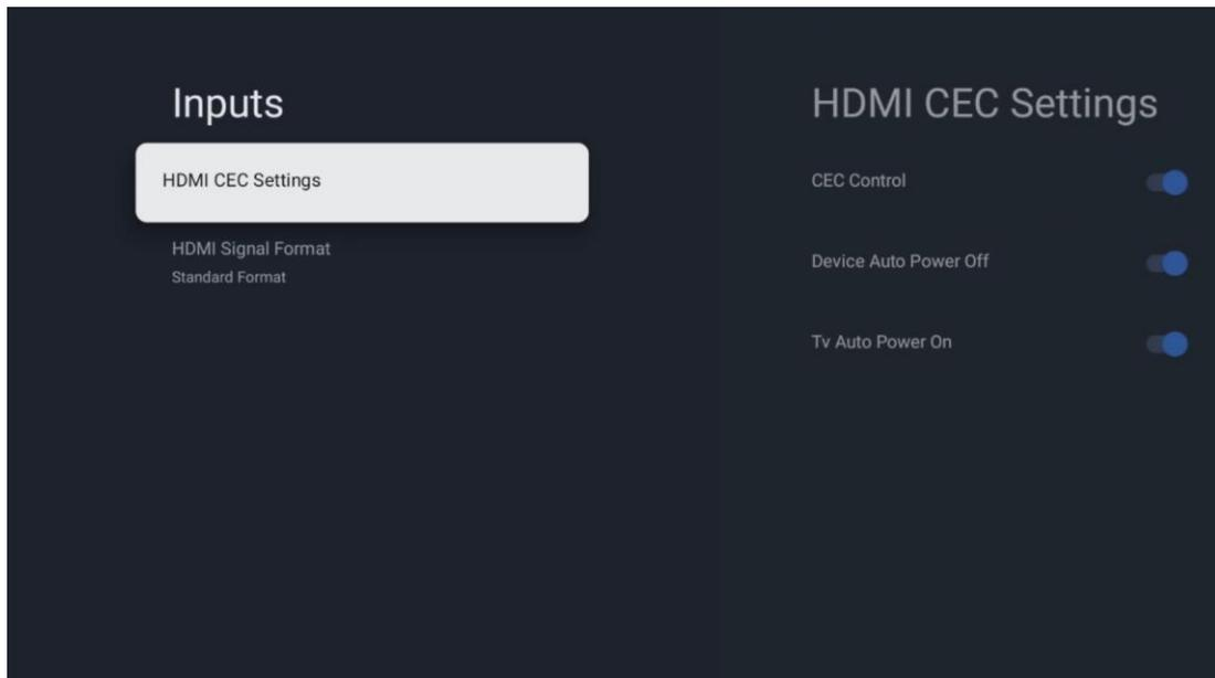
Si la fonction HDMI CEC (Consumer Electronics Control) est activée, vous pouvez commander l'appareil externe connecté à l'une de vos connexions HDMI à l'aide de la télécommande du téléviseur. Pour que cela fonctionne correctement, l'appareil externe connecté doit également prendre en charge la fonction HDMI CEC, celle-ci doit être activée et le fonctionnement de la fonction HDMI CEC de l'appareil externe connecté doit être synchronisé avec la fonction HDMI CEC du téléviseur.
